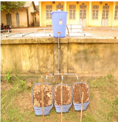
Ảnh 4. Xác định áp lực nước, lưu lượng nhỏ giọt thích hợp và miền thấm trong đất do tưới nhỏ giọt (thí nghiệm 1)
